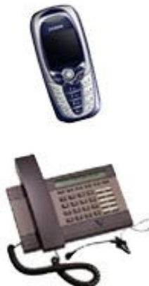
Brug Deres telefonnummer som identifikationskode for åbnesignal, ring til den indbyggede GSM modtager, som aflæser opkalders telefonnummer og videresender dette som en nøgle til låsecomputeren som herefter giver åbnesignal hvis nummeret er oprettet i systemet.
